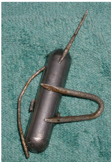
Le bout de broche (clou, vis, etc.) étant relativement lourd en comparaison de la fibre alimentaire se retrouve au même endroit que l'aimant et s'y accole.
