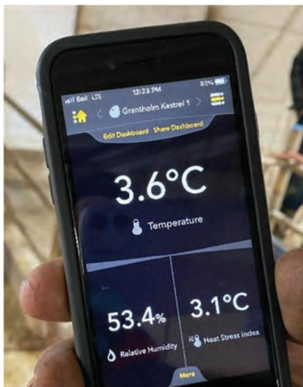
Les enregistreurs de données environnementales sont utilisés pour la surveillance de l'humidité et du stress thermique dans les installations d'élevage de veaux, de génisses, de vaches laitières et de vaches taries.
