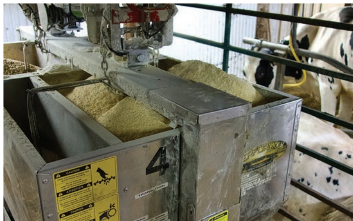
Le DAC sert à distribuer les grains, deux sources de protéines, la moulée de transition et les minéraux.
