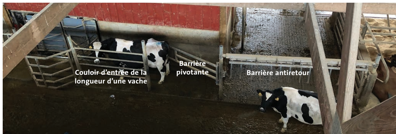
FIGURE 2: EXEMPLE DE CONCEPTION DE BARRIÈRE D'ENTRÉE DU ROBOT QUI PROTÈGE LE COU ET LES ÉPAULES DE LA VACHE SUIVANTE DANS LA FILE ET DÉCOURAGE LES COMPORTEMENTS DE COMPÉTITION
