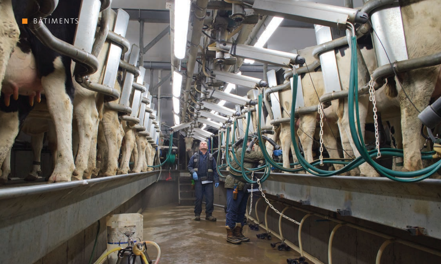
La salle de traite est équipée d'un double 12 de type « swing over ». Comptant seulement trois ans d'usage, il a coûté le quart d'un équipement neuf.
