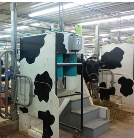
Distributeur d'aliments qui permet de contrôler précisément le moment et la quantité de ration offerte à chaque vache.
